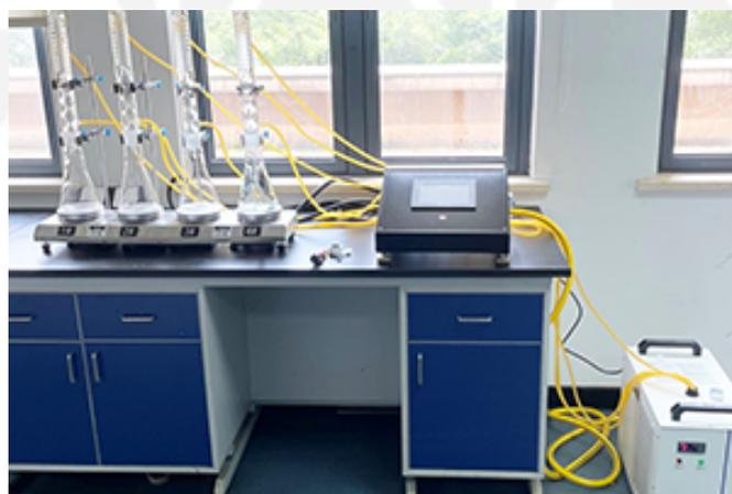
晶间腐蚀设备
